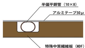
半扁平銅管採用により丸管仕様より伝熱性向上
